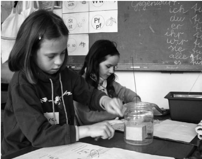
Abb. 7: Kinder tauchen unterschiedlich schwere, gleich große Würfel in das Wasser: Der Wasserstand bleibt gleich!
